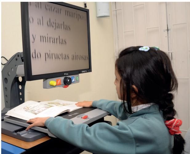
• **Circuito cerrado de televisión (CCTV) o de magnificación**, es un sistema compuesto por una cámara de televisión-TV conectada a un monitor.
